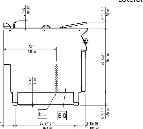
EI = Conexión eléctrica (energía)
